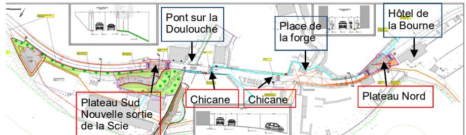
L'essentiel porte sur la création de 2 plateaux traversants aux entrées Sud et Nord, de chicanes dans la partie centrale pour limiter l'accélération entre les plateaux et de chicanes à proximité de l'intersection avec la D 35 (non visibles sur le plan ci-dessus).
